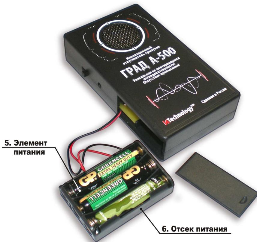
Рисунок 3 – схема установки элементов питания в корпус изделия.
